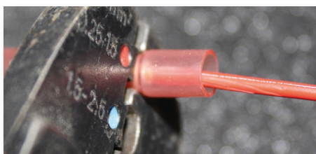
Fig 3.1.2a - För in den skarvade kabeländan i skarvhylsan och kläm åt med kabelsko-tången. Gör detta med båda kabeländarna.
