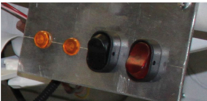
Fig 5.3.1a - De digitala ingångarna kan t.ex. kopplas till en knapp för att styra eller aktivera olika funktioner, som t.ex. launch-control.
