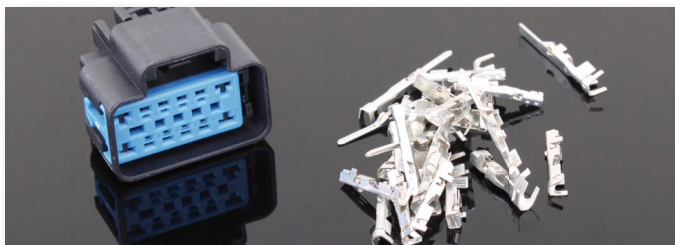
Fig 4.1.2c - 12-poligt kontaktstycke för inkoppling av strömförsörjning, knappar, varningslampor, varvräknare och liknande. Även MaxxECUs strömförsörjning ska gå igenom detta kontaktstycke. Tanken bakom detta "extra" kontaktstycke är att man i princip ska kunna lossa två kontaktstycken (detta och 48-pinnars Molex kontakten) och då kunna "lyfta ur motorn inkl kabelhärva" utan att behöva klippa några kablar.
