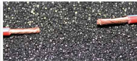
Fig 3.1.1c - Kabeländarna avskalade och ihoptvinnade för att inte spreta isär.
