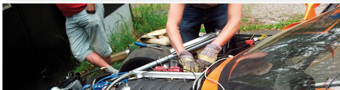
Fig 7.2.1i - Försök starta motorn, notera så att inte spänningen sjunker under 8v till MaxxECU (kommunikation upphör). Aktivera gärna loggning för framtida felsökning ifall motorn inte startar i detta skede.
