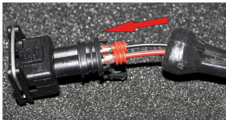
Fig 3.1.4e - För in kontaktstiftet i kontaktdonet tills det hörs ett "klick". Stiften ska ej pressas i med våld.
