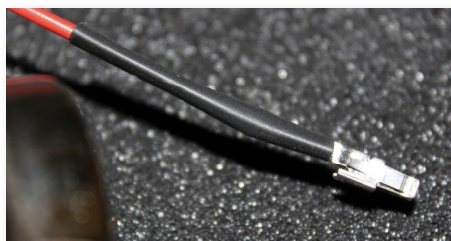
Fig 3.1.5d - Vi rekommenderar att använda krympslang med lim även i detta fallet för att skydda, trä på och värm med varmluftspistol.
