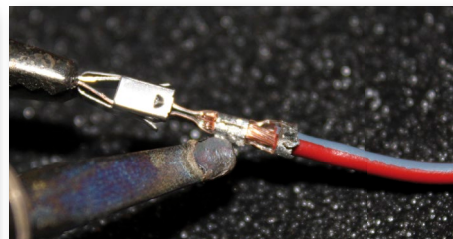
Fig 3.1.5c - Värm upp stiftet med varmluftspistol och tillsatt lödtenn, smält ihop.
