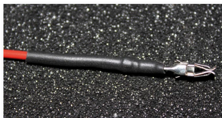
Fig 3.1.5e - En färdig kabelkontaktering som har utförts med lödning.
