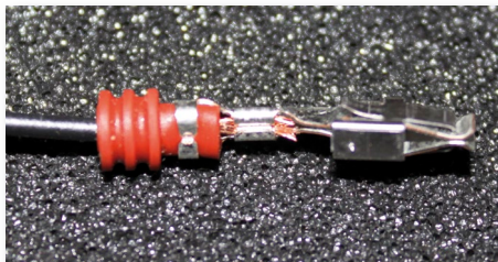
Fig 3.1.4d - En bra kontaktering klämmer fast både isolering (dragavlastning) och den elektriska ledaren.
