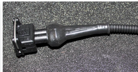
Fig 3.1.4f - Trä över skyddsgummit och klä kabeln med t.ex. robotslang.
