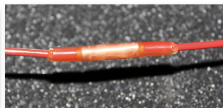
Fig 3.1.2c - Färdig kabelskarv. När limmet precis har trängt ut i kanterna är skarven mest hållbar.
