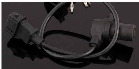
Fig 5.1.6d - Bosch vevaxelgivare (VR) som ofta används när original monterade givare inte fungerar som de ska. Kräver oftast tillverkning av nya triggerfästen och nytt pulshjul.
