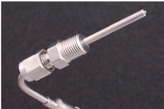
Fig 5.2.0g - Temperaturgivare (typ-k) med 1/8 NPT anslutning för mätning av t.ex. temperatur utifrån turbo. Ansluts via MaxxECU mini-k.
