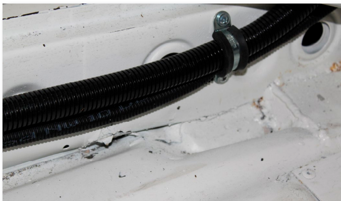
Fig 3.2.1g - Exempel på användning av robotslang och tejp. Installationen blir snyggare och säkrare.
