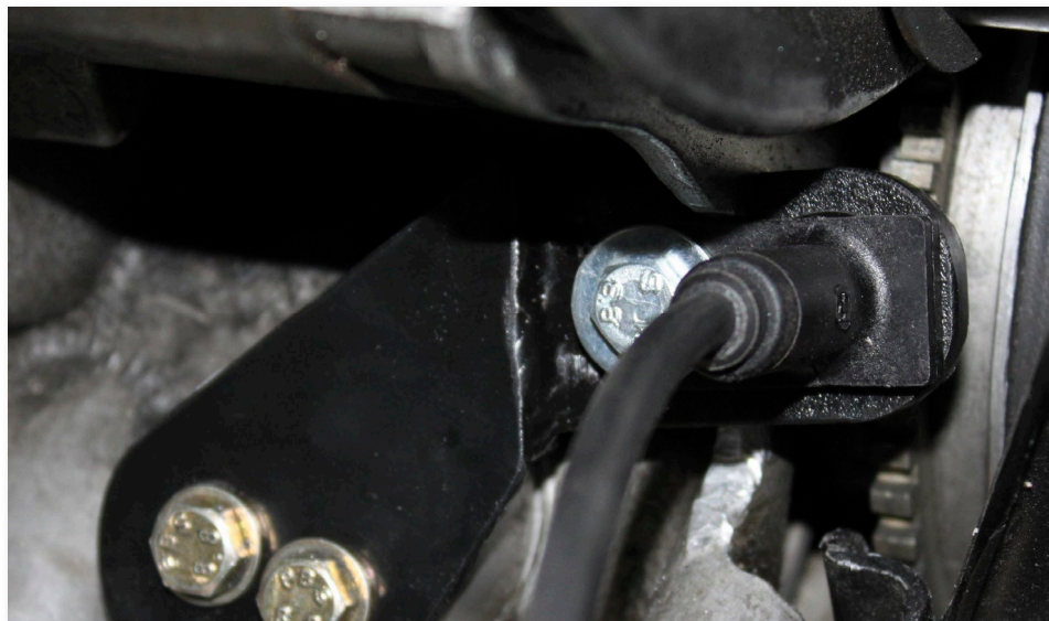
Fig 5.1.5a - Specialtillverkat triggerfäste för bosch vevaxelgivare på en porsche 911.
