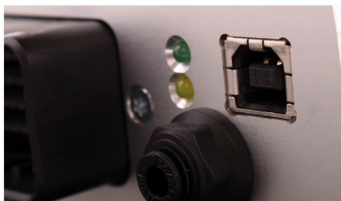
Fig 4.3.2c - MaxxECU har två indikeringslysdioder på samma sida som kontaktstycket.
