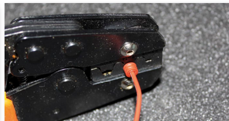
Fig 3.1.4c - Trä i kabel med tätningen i hylsan och kläm åt med tillhörande pressverktyg.
