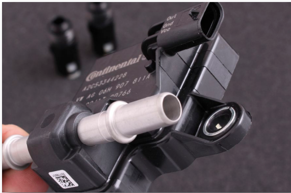
Fig 5.2.0e - Digital etanolvivare för avläsning av bränsletemperatur samt etanolhalt.
