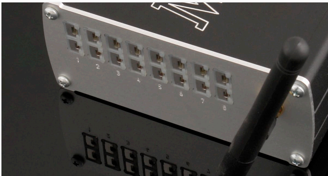
Fig 5.2.7b - På sidan av MaxxECU-enheten kopplar man in avgastemperatur-givarna.
