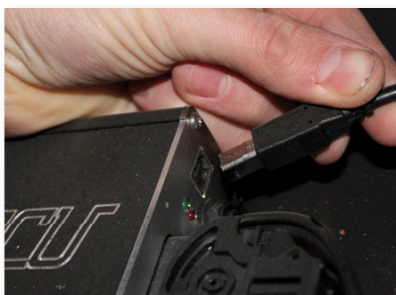
Fig 4.2.2c - Anslut den medföljande USB-kabeln till USB-porten på din MaxxECU-enhet. Försök att alltid låta USB-kabeln sitta monterad i MaxxECU-enheten för framtida användning.
