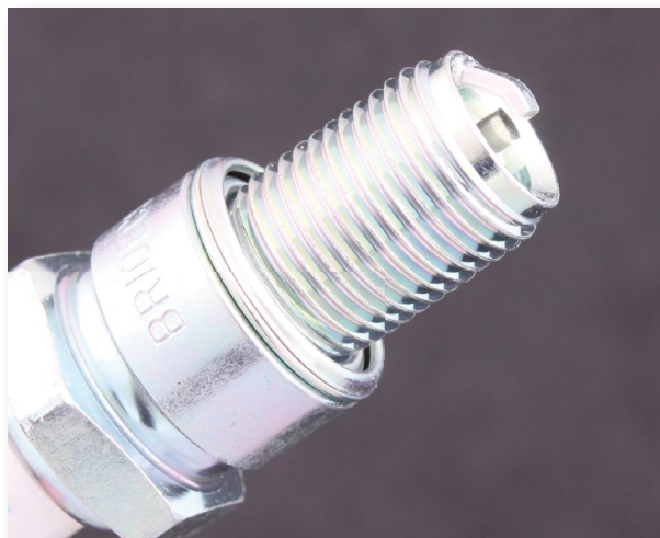
Fig 6.1.2c - NGK tändstift BR10ECS som är lämpligt att användas till metanolmotorer. Bra ersättare för äldre icke avstörda tändstift som ofta används på överladdade V8 motorer.
