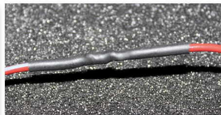
Fig 3.1.3f - En bra och hållbar lödskarv med krympslang ser ut så här.
