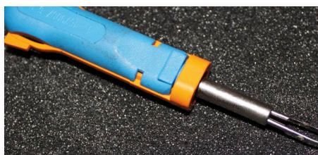
Fig 3.1.6a - Verktyg för att på ett säkert sätt demontera kontaktstift utan att göra åverkan på kontaktstiftet.
