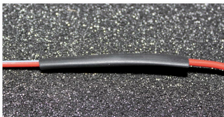
Fig 3.1.3d - Dra över krympslangen och placera den över mitten på skarven. Se till att inte ha den för nära lödkolven då de krymper vid hög värme...
