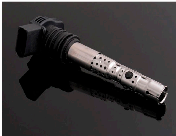
Fig 6.1.1b - VAG-tändspole används ofta eftersom det är en relativt billig och bra tändspole med inbyggt tändsteg vilket innebär att man inte behöver någon extern elektronik mellan spole och MaxxECU.
